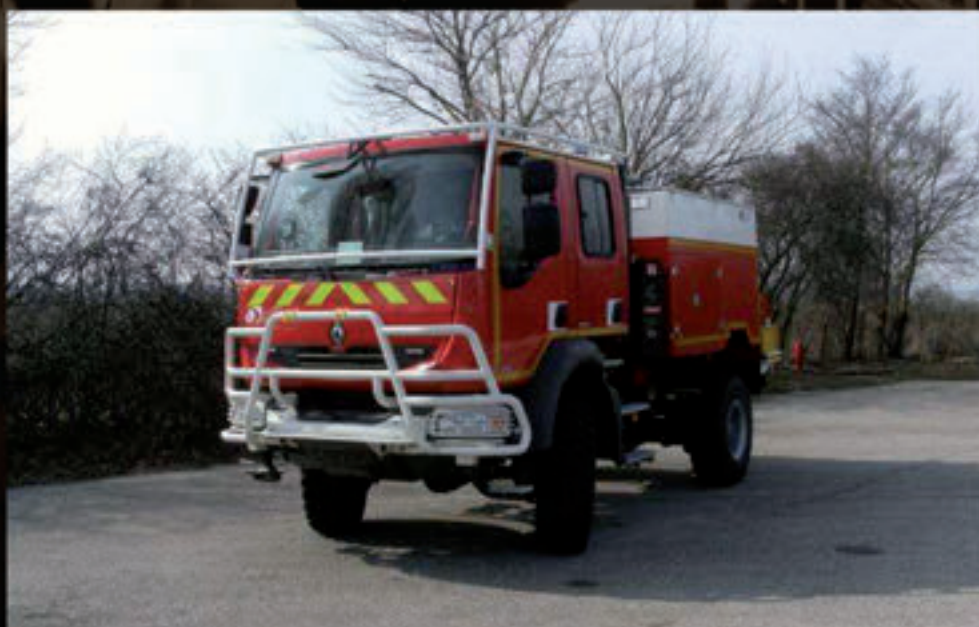
CAMION CITERNE FEUX DE FORÊTS MOYEN MEDIUM-SIZED FOREST FIRE TANKER TRUCK #VHLCCFFM
